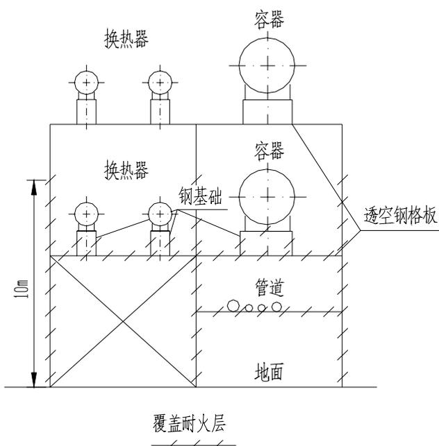
图2 多层构架(楼板为透空的钢格板)
