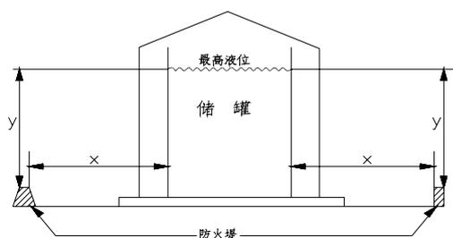
图 6.3.6 单防罐至防火堤内顶角线的距离
