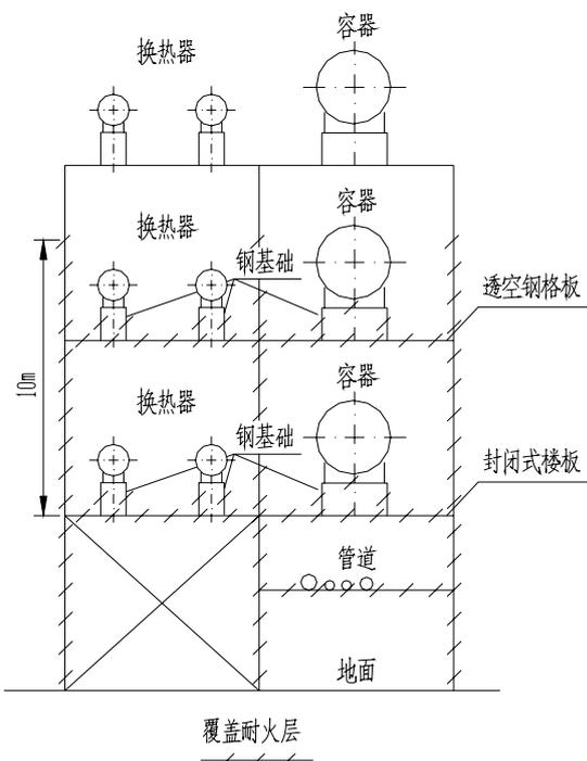
图 3 多层构架 (楼板为封闭式楼板)
