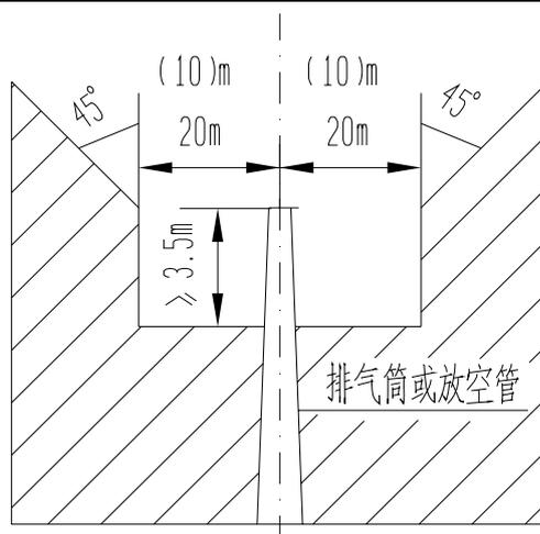
图 5.5.11 可燃气体排气筒、放空管高度示意图
